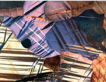
变形弯晶马口铁，200 倍
